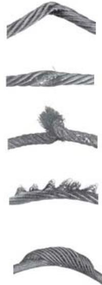
El Cable se debe desechar cuando estos defectos puedan provocar un mal funcionamiento del Aparejo de Elevación o poner en peligro la seguridad de la operación.
