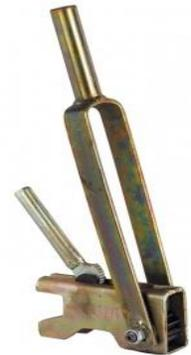
*NOTA: No trate de utilizar los Tensores para halar o sacar varillas del concreto cuando este ya este endurecido*
